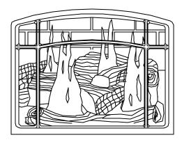
FIGURE 13 BURNER FLAME APPEARANCE
